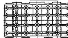
Оснастка изготовлена гнуто сварным методом не требует привлечения металлургического литейного и модельного производств.
